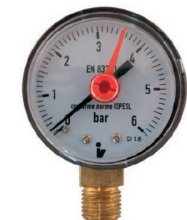
Tlakoměr spodní pro měření tlaku v rozvodech topení, vody a stlačeného vzduchu, závit 1/4", Ø 63, tlaky 0–4 bar; 0–6 bar; 0–10 bar.
