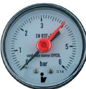
Tlakoměr zadní pro měření tlaku v rozvodech topení, vody a stlačeného vzduchu, závit 1/4", Ø 63, tlaky 0–4 bar; 0–6 bar; 0–10 bar.
