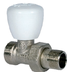
Ruční ventil Fornara jednoregulační – ROHOVÝ se závitěm G3/4" eurokonus pro připojení na měděné nebo plastové potrubí pomocí svěrného šroubení.
