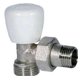
Ruční ventil Fornara jednoregulační – ROHOVÝ se závitěm G3/4" eurokonus pro připojení na měděné nebo plastové potrubí pomocí svěrného šroubení.
