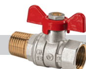
ONYX Kurek kulowy pełnoprzelotowy z dławikiem z motylikiem aluminiowym, wersja nakrętno-wkrętna
