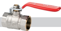
ONYX Kurek kulowy pełnoprzelotowy z dławikiem z dźwigni stalową, wersja nakrętno-nakrętna
